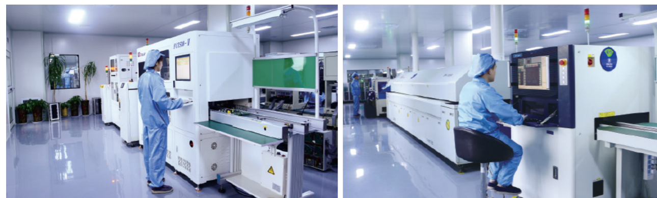
PCB 板调试 -FCT、ICT 功能测试流水线
